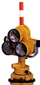
Комплект трехпризменного держателя с адаптером и трегером и регулировкой по наклону
