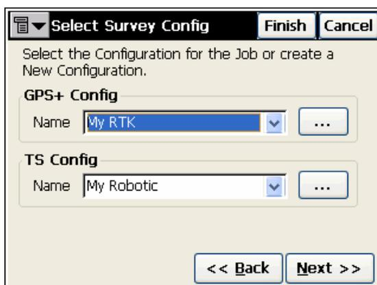
Рисунок 3-61. Выбор конфигурации съемки
