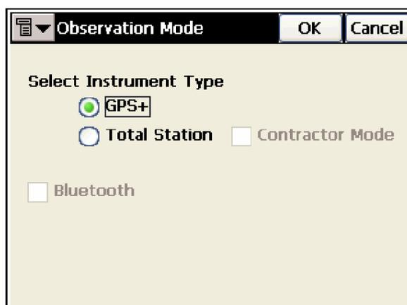
Рисунок 3-1. Экранная форма *Observation Mode (Режим наблюдений)*
