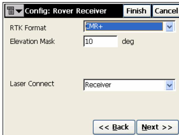
Рисунок 3-11. Экранная форма *Config: Rover Receiver* (Настройка: Подвижный приемник), режим RTK
