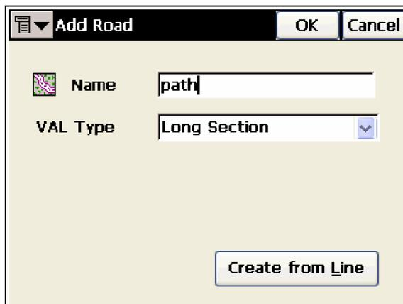
Рисунок 4-31. Добавить трассу - выбор типа VAL (вертикальной разбивки)
