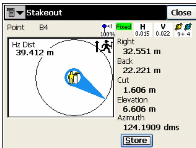
**Рисунок 7-26. Разбивка - рабочее окно при использовании GPS+ приемника**
